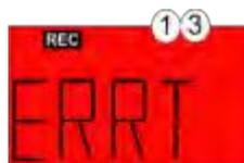
Fig. 4-9. - Errore trasformatore toroidale
