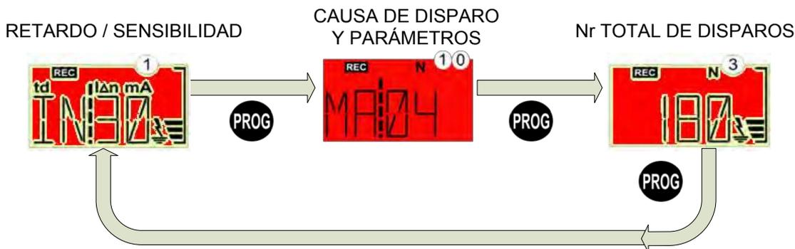
Fig. 4-6. - Schermate in stato di sgancio causato dall'interruttore
