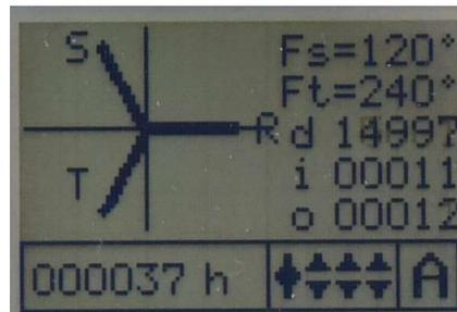
Trascorso il tempo di attivazione previsto dalla norma, (Visualizzati in decremento) viene comandata la chiusura del DDI . Nelle altre aree di monitor si ha l'indicazione dello stato dei relè di uscita e del modo di lavoro, mentre nella zona tempo attivazione viene monitorizzato l'orologio indicante il tempo di lavoro.
